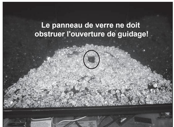
Figure 11.6 Ouverture de la veilleuse sans élément d'apparence en verre
