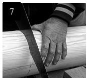
Utilice una sierra de diente fino para cortar la columna. Corte a través la pared y ruede la columna para seguir exactamente la línea.
