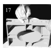
Marque la línea central en los cuatro lados de la base para asistir con la alineación.
