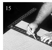
Utilizando una escuadra, dibuje una línea central perpendicular al borde exterior de la plataforma.
