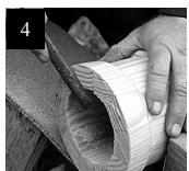
Utilice una escopina para nivelar los cortes para que el peso sea distribuido uniformemente a través de la superficie de la columna.
